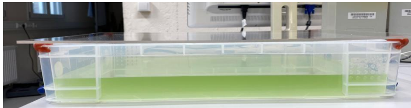
Abbildung 3: Open Pond für Freiland Kultivierung mit Chlorella vulgaris Lösung
