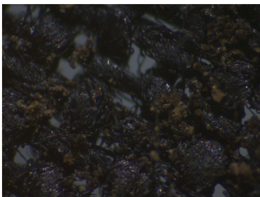
Abb. 32: Versuch D - Untersuchung der biologischen Abbaubarkeit unter natürlichen Bedingungen - Probe 5 - Lichtmikroskopische Aufnahme des Zustandes am 02.02.22
