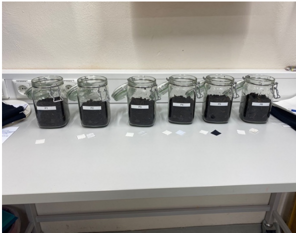
Abbildung 1: Versuch D - Untersuchung der biologischen Abbaubarkeit unter natürlichen Bedingungen - Versuchsgefäße vor Eingrabung der Versuchsproben
