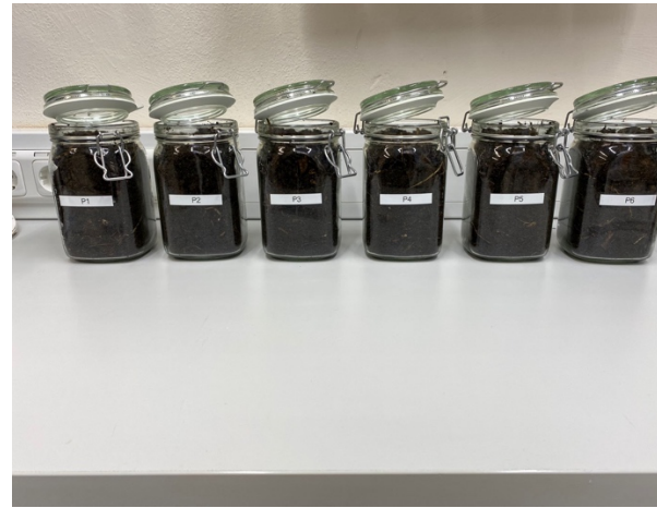
Abbildung 2: Versuch D - Untersuchung der biologischen Abbaubarkeit unter natürlichen Bedingungen - Gefüllte Versuchsgefäße mit eingegrabenen Versuchsproben
