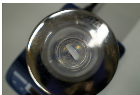
Abbildung 4: Lösevorgang von PMMA in Toluol auf dem Heizrührer
