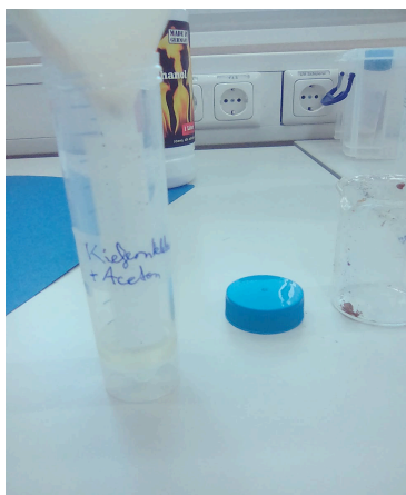
Abb. 5: Kiefernkleber mit Aceton filtriert
