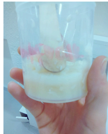
Abb. 4: Kaseinkleber mit Sumpfkalk
