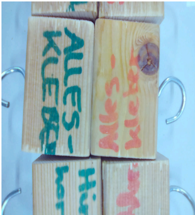
Abb. 1: Holzblöcke mit Kaseinkleber
